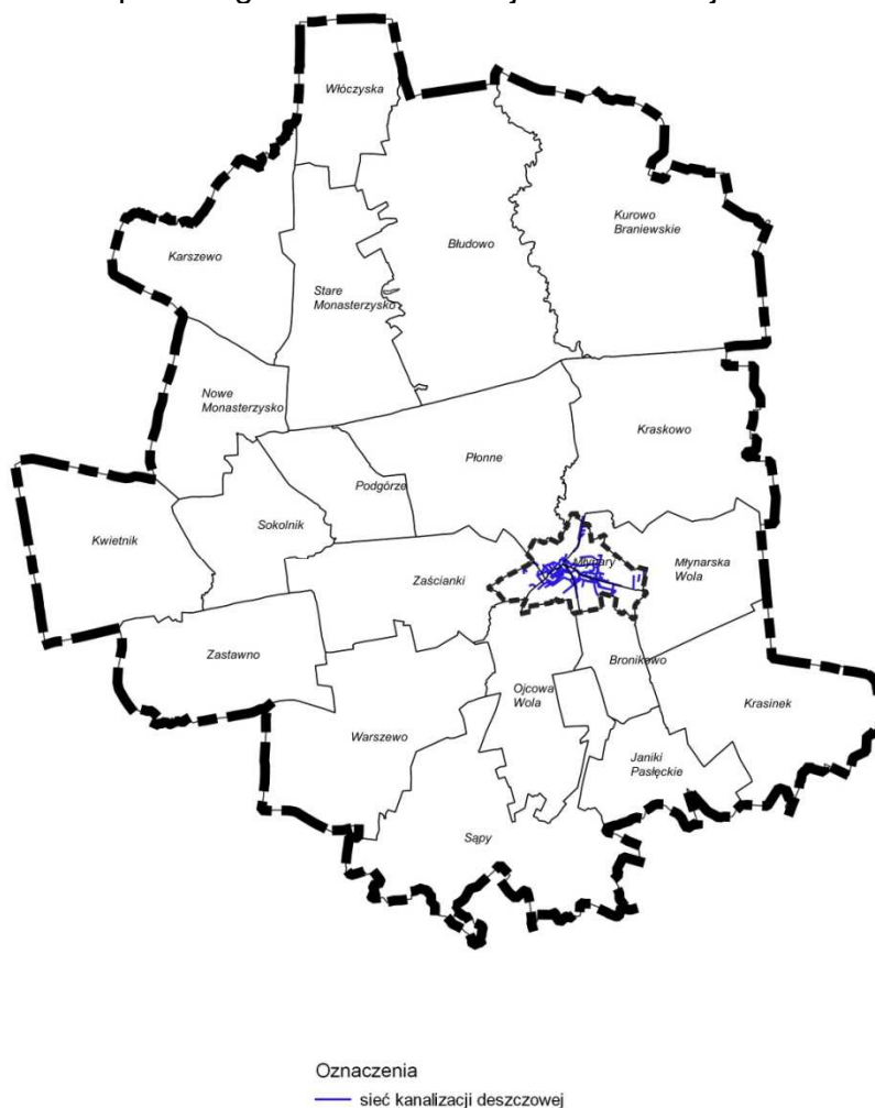
Rysunek 8: Schemat przebiegu sieci kanalizacji deszczowej
