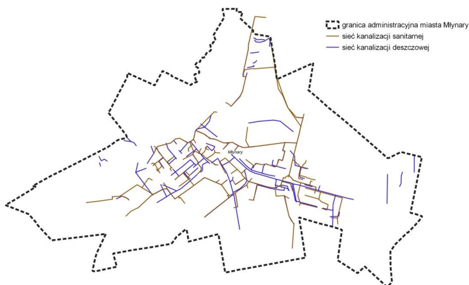
Rysunek 9: Przebieg sieci kanalizacji sanitarnej i kanalizacji deszczowej na terenie miasta Młynary
