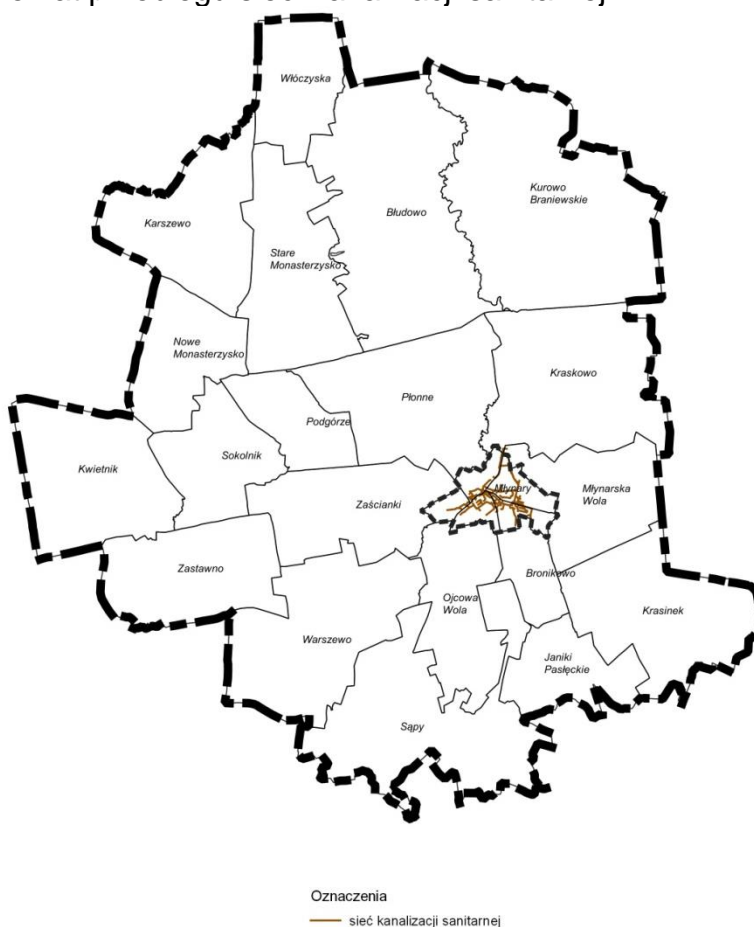
Rysunek 7: Schemat przebiegu sieci kanalizacji sanitarnej
