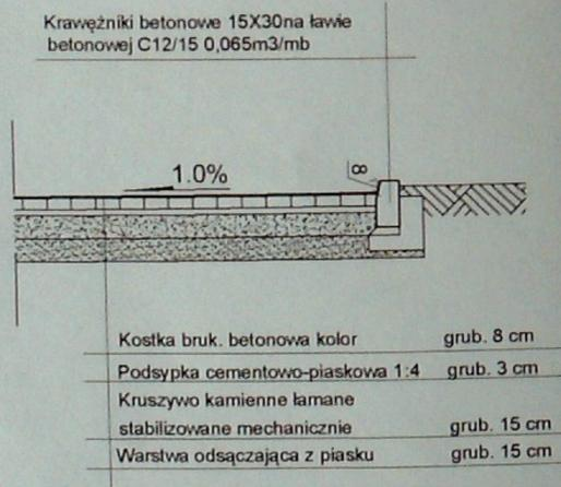
UTWARDZENIE Z PŁYT BETONOWYCH
